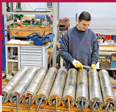
Reparaturhalle Vorbeugende Instandhaltung und Refabrikation von Bauteilen, Tauch- motoren und Pumpen.
